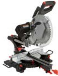
Para cortar revestimientos de acero, una opción es utilizar una sierra de inglete deslizante. Nunca se sumerja en el panel de acero, comience con el panel de acero y luego empuje hacia abajo y a través del panel lentamente.
